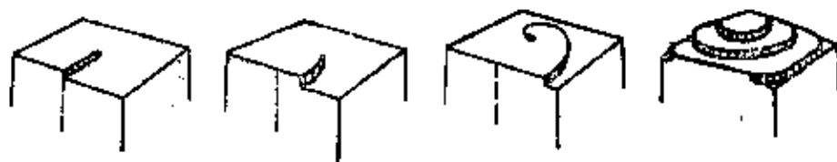
图 2-22 螺旋位错露头处生长蜷线的形成
