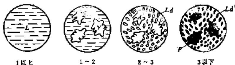
图 4-18 w_C = 3.0\% 的白口铁结晶过程示意图
