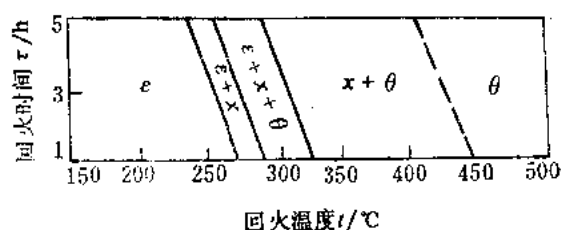
图9-72 淬火高碳钢 ( w_C=1.34\% ) 回火时碳化物转变温度和时间关系
