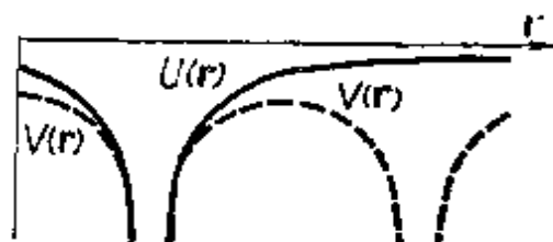
图 5.5 原子和晶体中的势能曲线 实线表示自由原子中电子的势能；虚线表示晶体格点中电子的势能，它沿两个格点的连线作出
