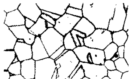
图 7-52 4% Mo-79% Ni-17% Fe 合金经退火后的显微组织 ( \times 85 )
