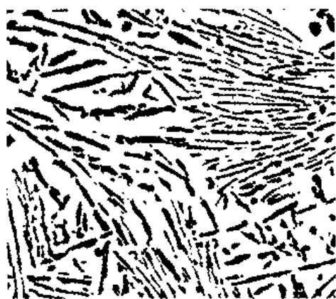
图 11-25 Al-Si 共晶组织 (基体为 Al) ( \times 200 )
