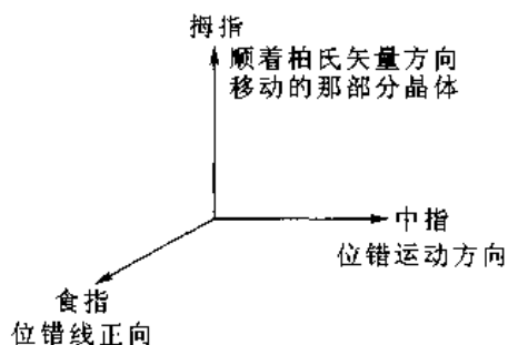
图 6-33 判定晶体滑动方向的右手定则说明
