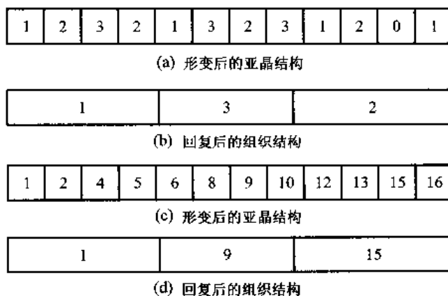
图 12-76 取向梯度对回复后的组织结构的影响
