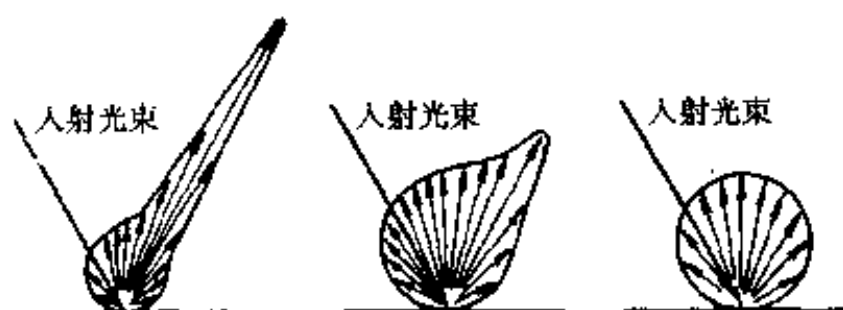
图 4.8 粗糙度增加的镜反射、漫反射能量图
