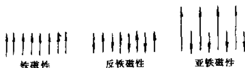
图 7.10 铁磁性、反铁磁性、亚铁磁性的自旋排列
