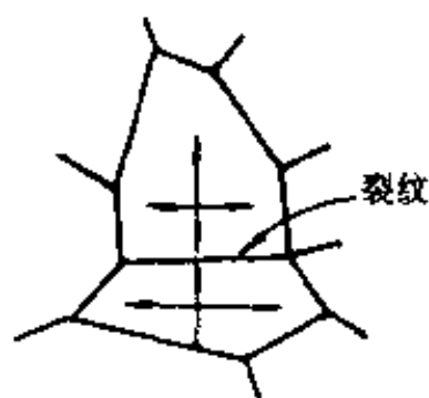
图 2.19 由于热应力形成的裂纹
