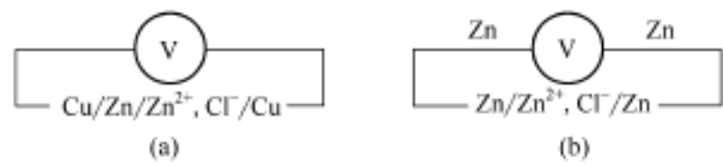
图 2.2.4 两种用于测量含有 \text{Zn}/\text{Zn}^{2+} 界面电池电势的装置
