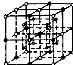
图 12-35 \beta 相体心立方点阵中 a, b, c, d 四个亚点阵 ●—— a ; ○—— b ; ●—— c ; ○—— d
