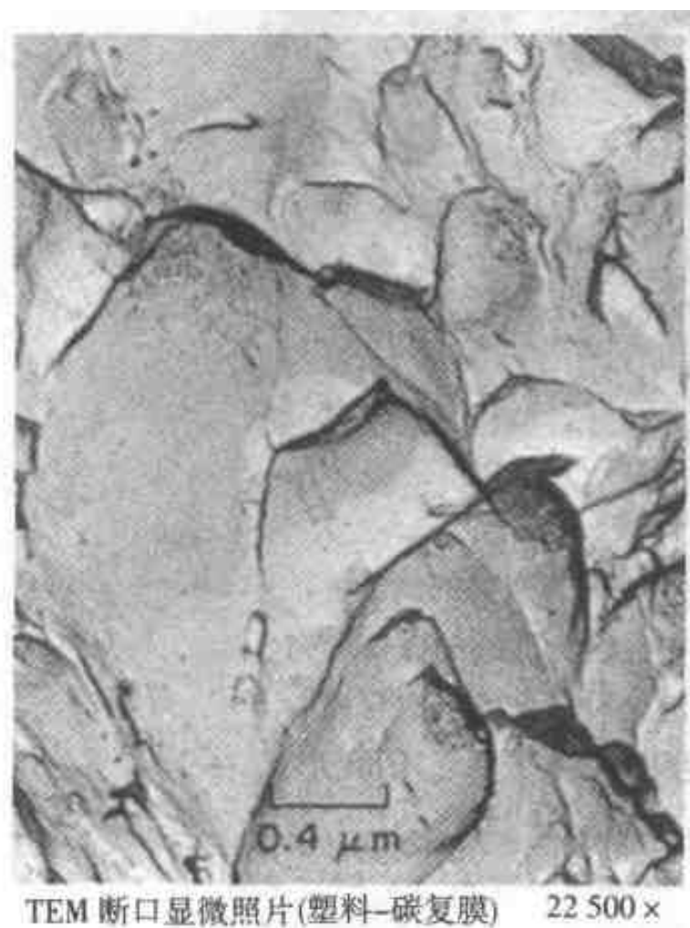
图 3.122 因在 TEM 的电子流中过度加热而形成的复膜网形的例子。这是一份显示镍断口中韧窝的塑料-碳复膜，用锡作遮蔽。网形是因为在显微镜中遮蔽金属熔化并形成液滴所致
