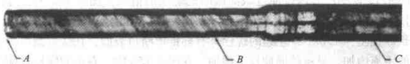
图 4.16 因扭转过载而破坏的轴的断口表面。A 点的断口表面垂直于页面。 在 A 和 B 之间可见到螺旋状线条，此为扭转变形带（引自 Metals Handbook [7] ）
