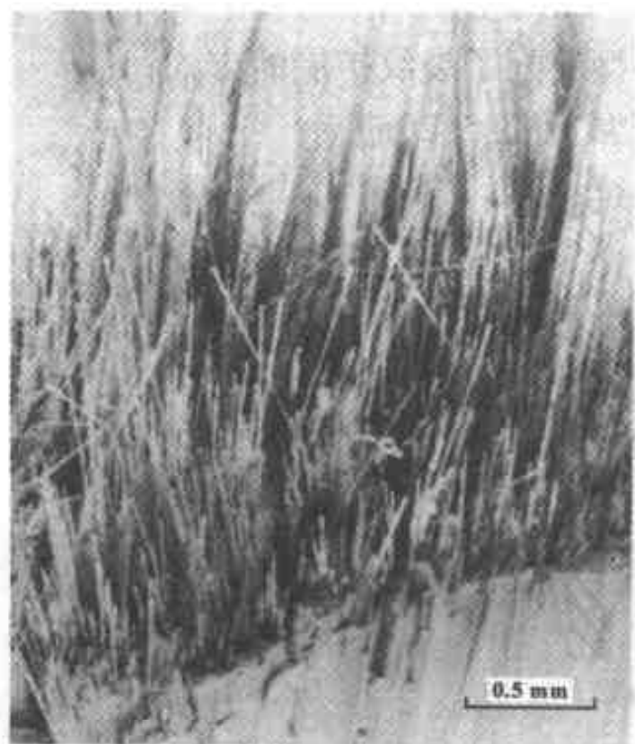
图 5.22 一种玻璃纤维-聚酯树脂薄板在纵向拉伸后的断口表面扫描电镜照片，显示出与大量纤维拉出有关的刷子状形貌（引自 Hull [1] ）
