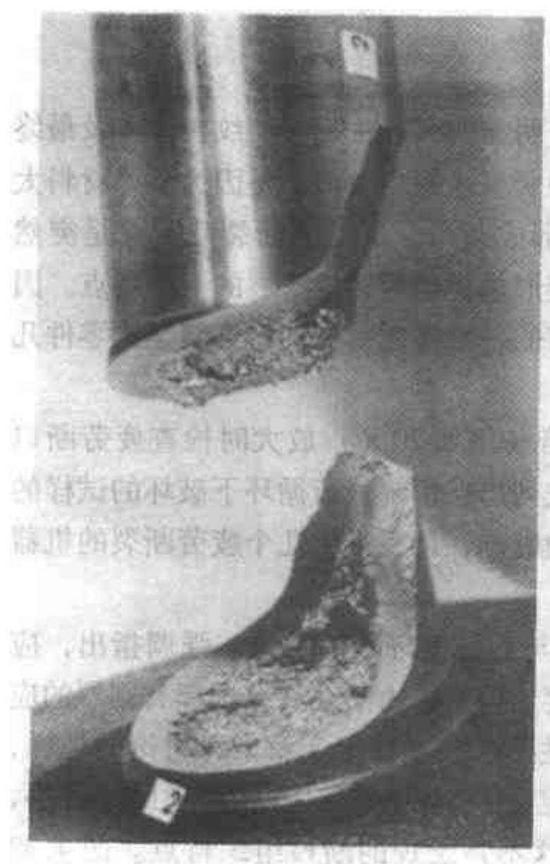
图 4.27 钢车轴，在实验室中因简单弯曲冲击过载而破坏。钢种为：变质 SAE 1050，含有 w(\text{C}) = 0.50\% 、 w(\text{Mn}) = 0.95\% 、 w(\text{Si}) = 0.25\% 、 w(\text{S}) = 0.01\% 及 w(\text{P}) = 0.01\% 。此热轧的并微粗的轴具有感应硬化表面（硬度为 60HRC）及珠光体——一次铁素体的心部（硬度为 20HRC）（引自 Metals Handbook [5] ）
