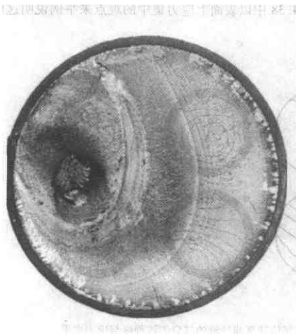
图 4.35 某疲劳失效的断口表面，显示在外围上沿着一个尖锐的弹性挡环槽而形成的细小的棘轮标记。椭圆形贝壳状标记的偏心模式说明轴上的载荷是不平衡的。此零件为 1050 钢的轴，硬度约为 35HRC，承受旋转弯曲 (引自 Wulpi [6] )
