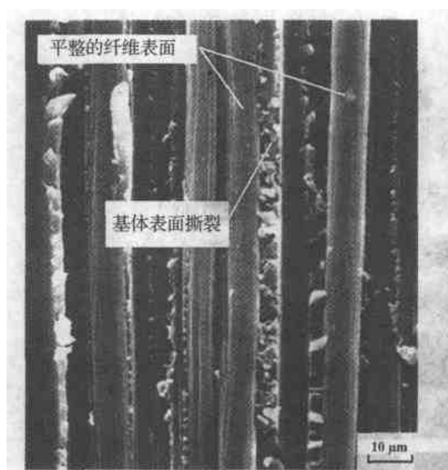
图 5.33 一种单向碳纤维 - 环氧树脂薄 板内部剪切断口的扫描电镜照片 (引自 Hull [1] )
