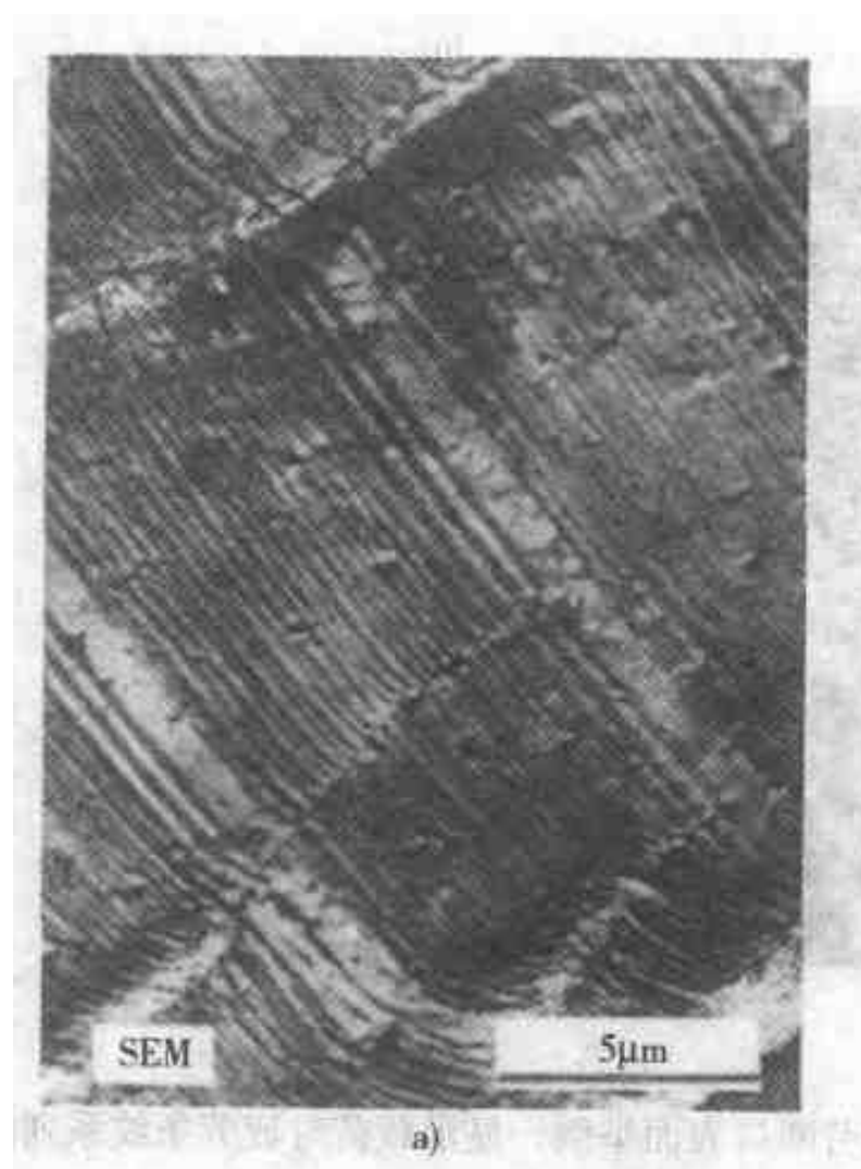
图 3.60 疲劳断口表面举例，显示载荷对疲劳条纹系列的影响
