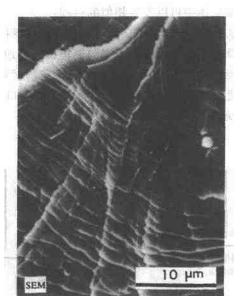
图 3.23 解理断口表面的断口显微照片，显示滑移痕迹。
