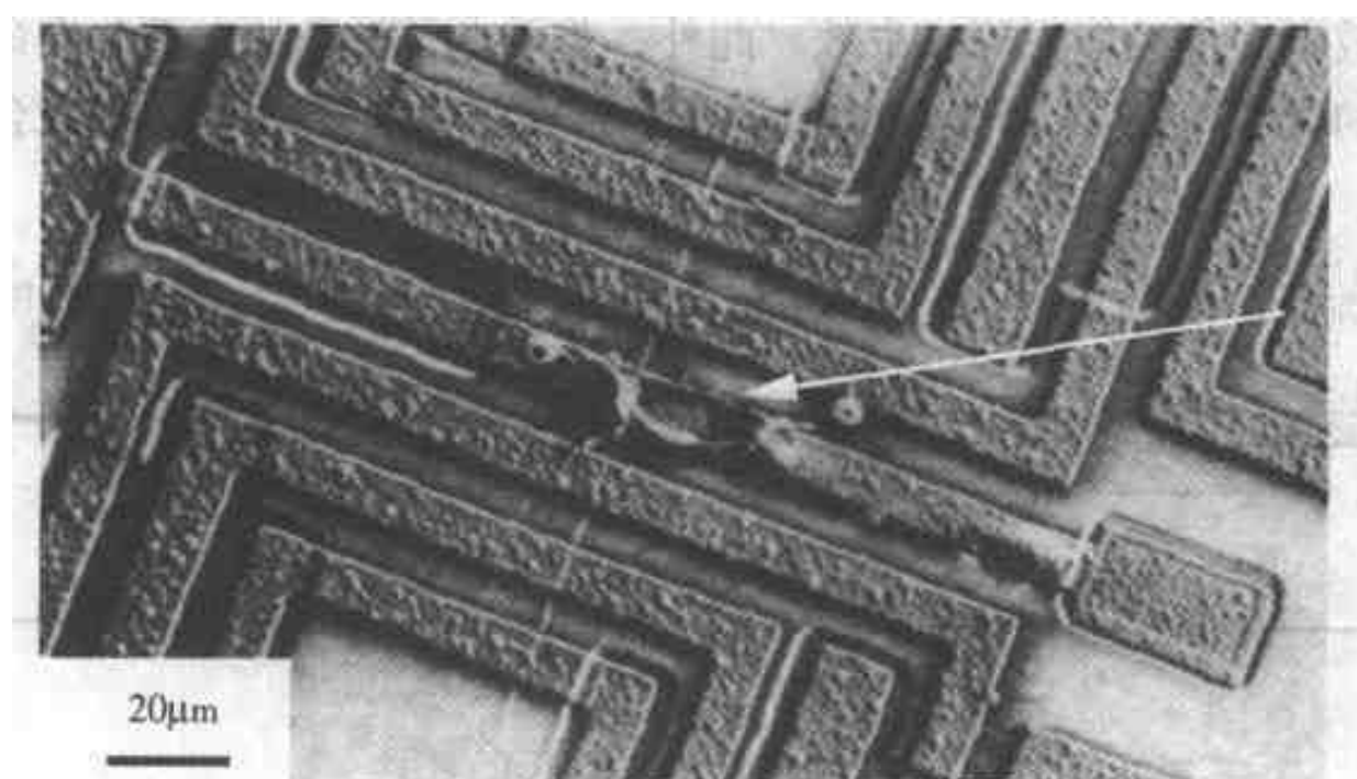
图 6.5 在 16K 动态存取存储芯片中电超载引起的金属敷镀层 (箭头) 熔化造成的损伤 (引自 Amerasekera and Najm [11] )
