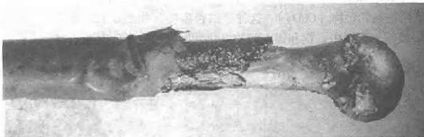
图 6.124 来自 28V 直流电源系统的导线样品，显示起弧损伤。注意熔成小球的端部和绝缘的恶化（引自 Slenski and Galler [48] ）
